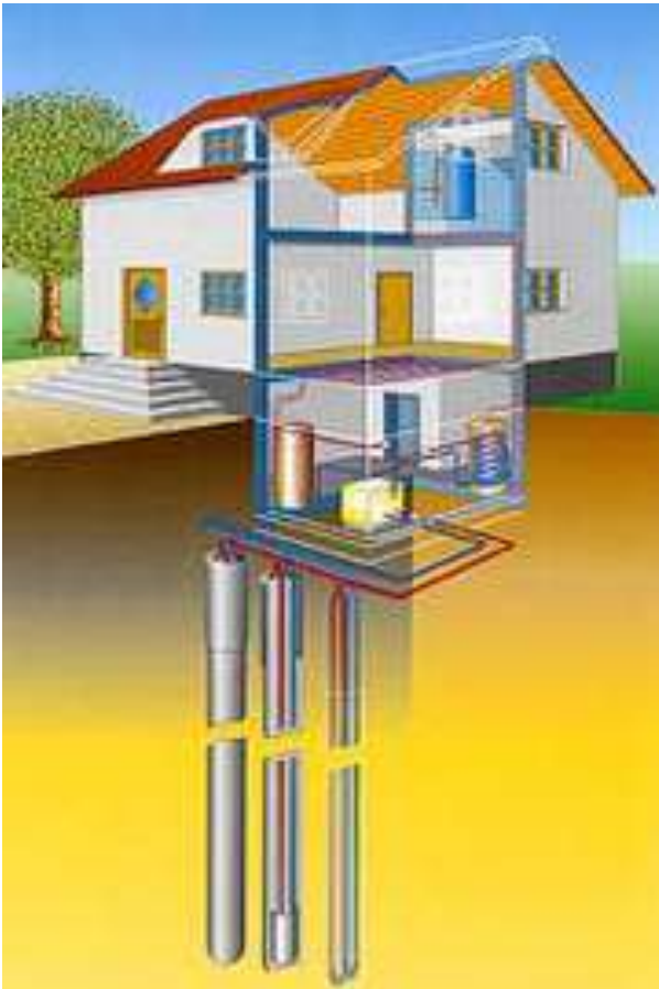
Figura 54. Schema di un impianto geotermico a bassa entalpia con le relative sonde geotermiche.
